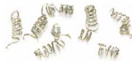
Свободно намотанная (витая) стружка идеальные условия резания
