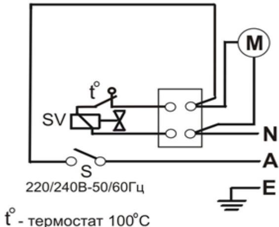
Электрическая схема на КГ-30
